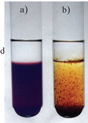
Resim B.8. a) \text{KMnO}_4 çözeltisi; b) \text{KMnO}_4 'in rengi, alkenin oksitleşmesinden dolayı, değişmiştir.
